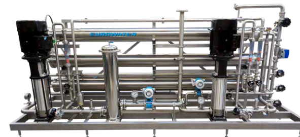
Jednostka podwójnej odwróconej osmozy o wydajności do 10 m 3 /h z możliwością sanitzacji gorącą wodą w temperaturze do 85 °C. Całość wykonana ze stali AISI 316L, przeznaczona do produkcji wody oczyszczonej (PW) według Farmakopei Europejskiej (EP). Szerokie zastosowanie również w przemyśle kosmetycznym.
