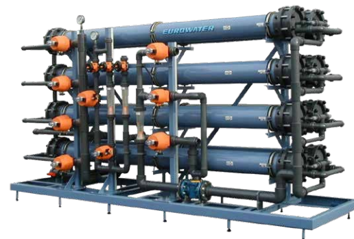
Stacje nanofiltracji wody
