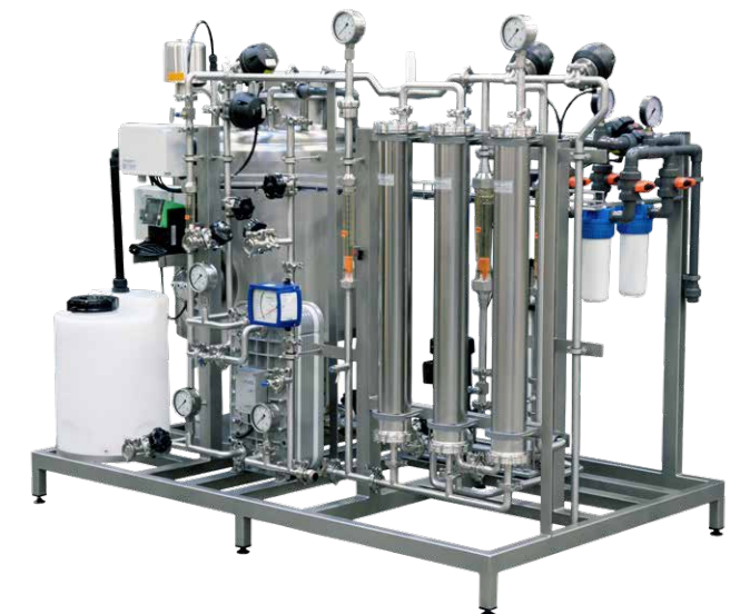
Jednostka podwójnej odwróconej osmozy o wydajności do 10 m 3 /h z możliwością sanitzacji gorącą wodą w temperaturze do 85 °C. Całość wykonana ze stali AISI 316L, przeznaczona do produkcji wody oczyszczonej (PW) według Farmakopei Europejskiej (EP). Szerokie zastosowanie również w przemyśle kosmetycznym.
