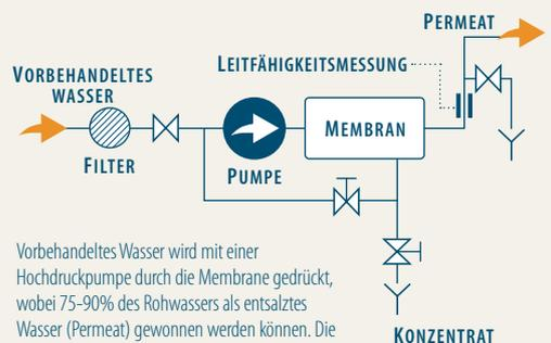
Vorbehandeltes Wasser wird mit einer Hochdruckpumpe durch die Membrane gedrückt, wobei 75-90% des Rohwassers als entsalztes Wasser (Permeat) gewonnen werden können. Die Salze werden von der Membrane zurückgehalten und fließen als Konzentratlösung ins Abwasser.
