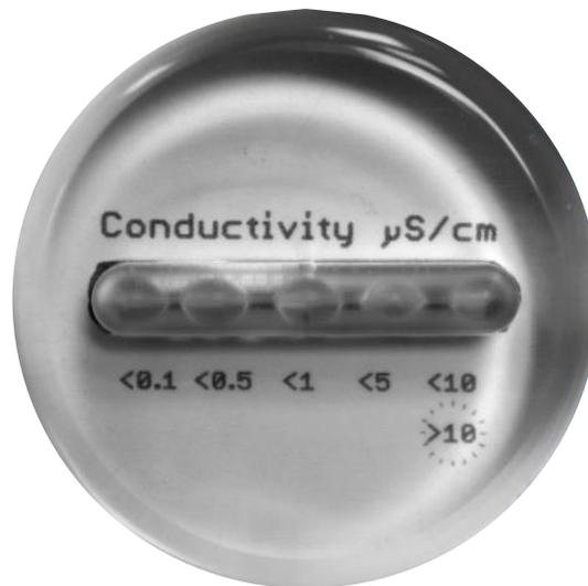
Abb. 3 – Leitfähigkeitsmessgerät Secon V3-10
