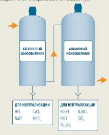
Когда емкость установки исчерпана, катионитовый фильтр регенерируют соляной кислотой, а анионитовый - гидроксидом натрия. Для сбалансированного использования ионообменной емкости системы и оптимизации потребления химикатов для нейтрализации, катионитовый фильтр часто имеет меньший объем.
